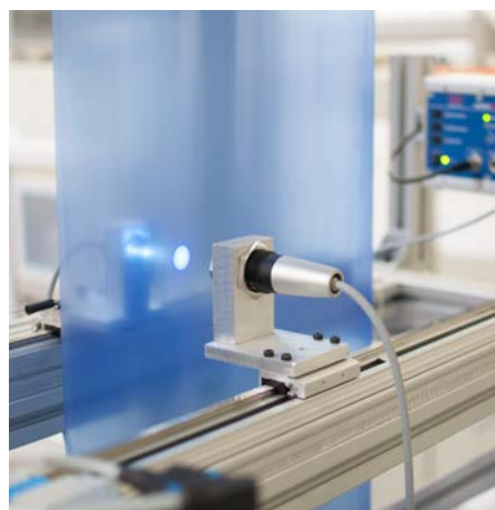
Misura della tonalità del colore dei film trasparenti e dei Vetri acrilici.
