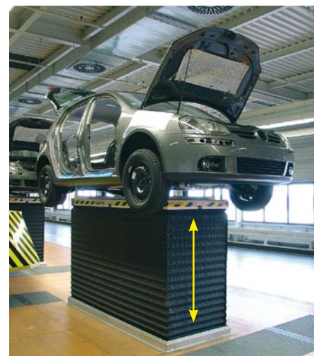
I sensori a filo controllano l'altezza delle piattaforme di sollevamento nelle linee di produzione auto.
