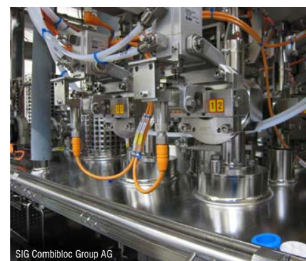
Misura dell'alzata delle valvole nell'industria alimentare Gli alloggiamenti in acciaio inossidabile della serie MDS45Mxx sono ideali per l'industria alimentare.
