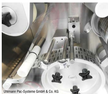
Rilevamento corpi estranei in campo farmaceutico Il sensore MDS riconosce corpi estranei durante il processo d'imballaggio dei blister.
