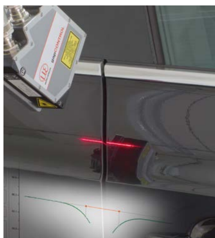
Misura del gap tra le parti di un veicolo
