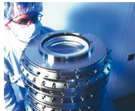
I sensori di misura capacitivi grazie alla loro altissima precisione permettono un perfetto allineamento delle lenti negli impianti litografici.
